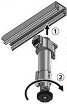
① ストッパーボタンをダクトレールの強制ビードと反対側に合わせて挿入する。
