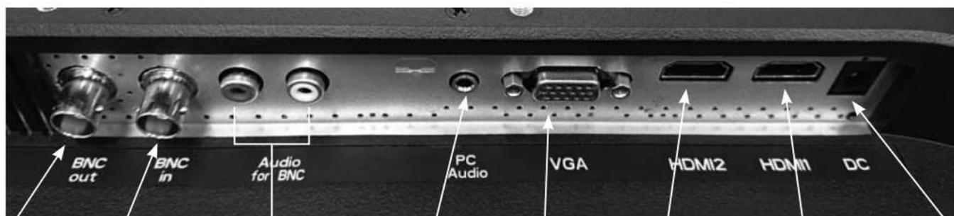
アナログ映像出力    アナログ映像入力    アナログ映像用音声入力    VGA用音声入力    VGA映像入力    HDMI2映像・音声入力    HDMI1映像・音声入力    DC12V電源入力
